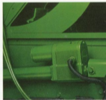
Med hjälp av en elmotor kan du justera slagskoöppningen under gång.
