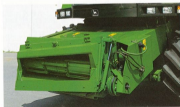
Inmatningshusets frontplatta är ledad, så att skärbordet alltid kan följa markkonturerna.
