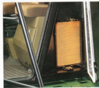
Luftfiltret är lättåtkomligt placerat.
