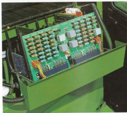
Samtliga elektronikbrettskort sitter i en gemensam box, som är lättåtkomligt placerad precis utanför hytten. Boxen är förseglad och väl skyddad mot damm och fukt.
